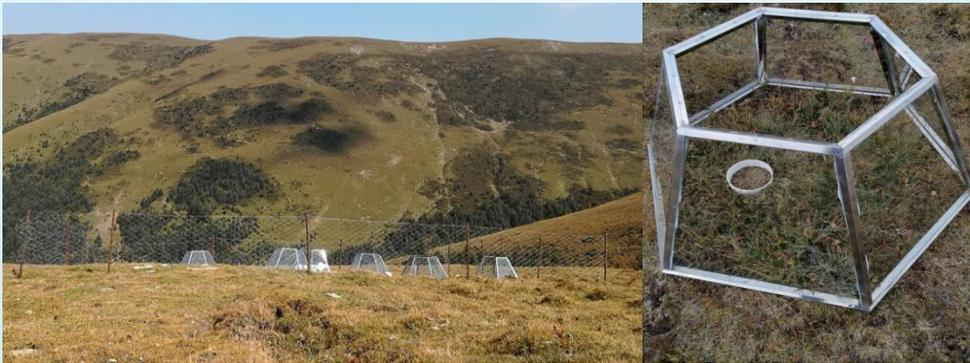
图 1 实验样地的设置和增温装置
