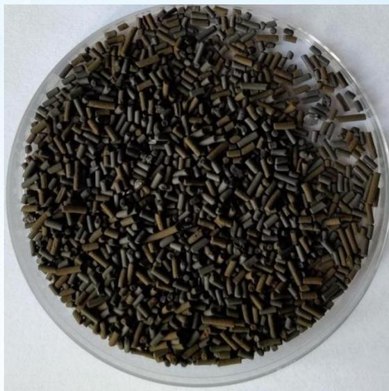
图 1 负载锰型空气净化材料
